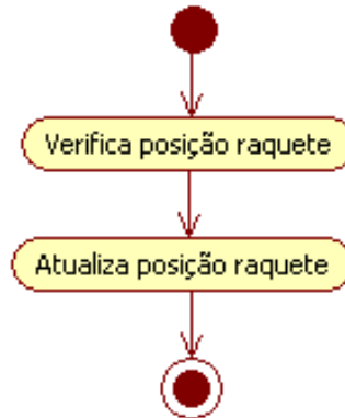
Figura 9 – Diagrama de atividade de “Mover raquete”
